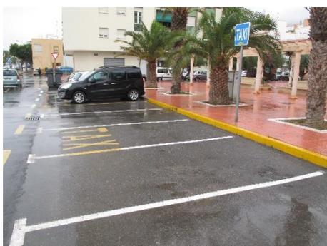
Así mismo, la acera de este tramo de la Rambla de las Cruces se encuentra a más de 15 cm de altura sobre la calzada, precisando de tramos de escalones y rampa, para salvar la diferencia de cota. Ninguno de estos elementos desembarca sobre la zona de acceso a los vehículos, de forma que se ha de transitar por la calzada para llegar hasta los mismos.
